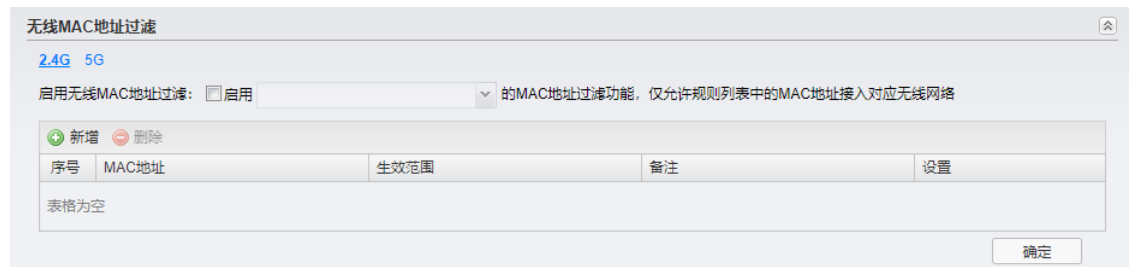
图 3-19 安全设置界面 - 无线 MAC 地址过滤区域
